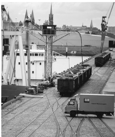
Перевозка силового кабеля для подводной прокладки в транспортной емкости
