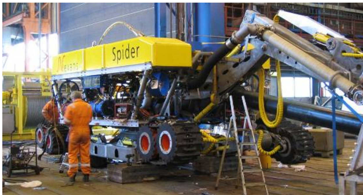
Дноглубительный аппарат SPIDER для прокладки кабелей
